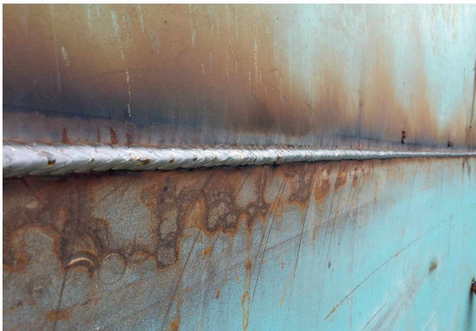
Figura 01: solda avaliada e preparada para o teste.
